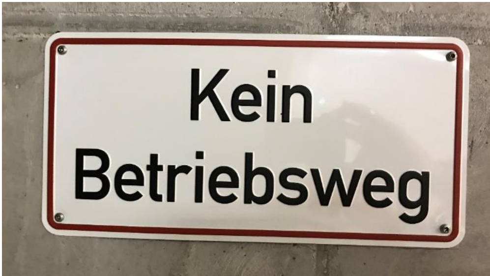
Abbildung 2: Kennzeichnung der Wege, die nicht zum Erreichen von Betriebsräumen genutzt werden dürfen
